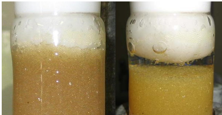
Figure 3: Résine Dowex 21k XLT avant alimentation (à gauche), après alimentation (à droite)
